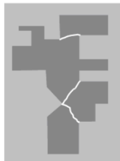
Figura 6: Delimitação de áreas de reparo não recomendada.
